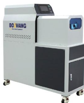
BZW-886CS 最大径: 30mm 最大ストリップ200mm 回転4枚刃
